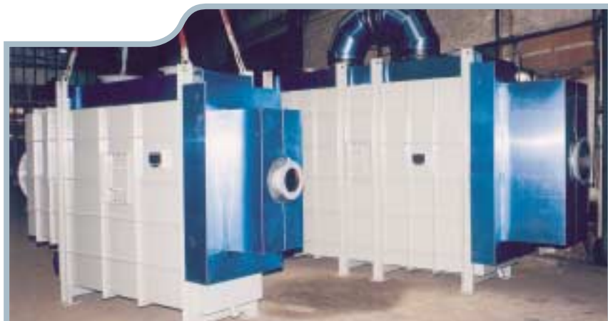
Echangeur gaz-gaz : faisceaux indépendants, garnissage intérieur du casing
