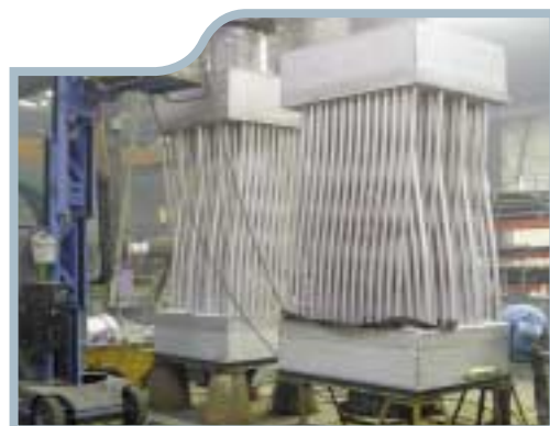
Récupérateur haute température en incinération
