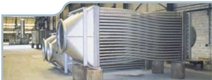
Faisceau pour récupération haute température sur fumées à 900°C
