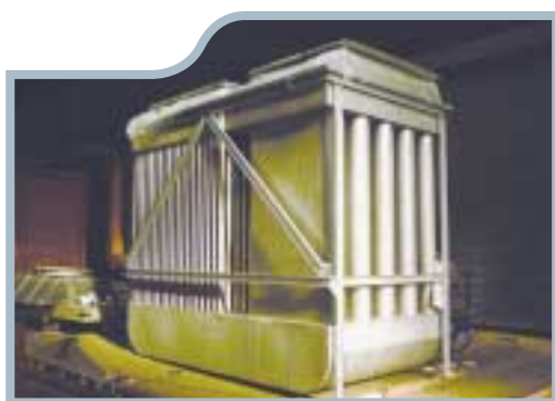
Récupérateur type "carneau" en sidérurgie
