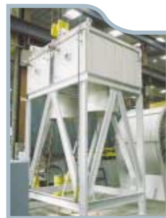
Aéroréfrigérant en tirage forcé
